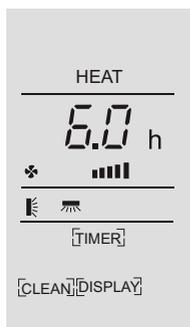
Рисунок 1 Задание включения по таймеру при выключенном кондиционере
