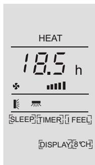
Рисунок 2 Задание выключения по таймеру при включенном кондиционере
